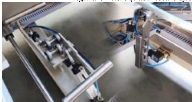
Figura 4 Pliere și asamblare eficientă a cutiei - controlul cilindrului
